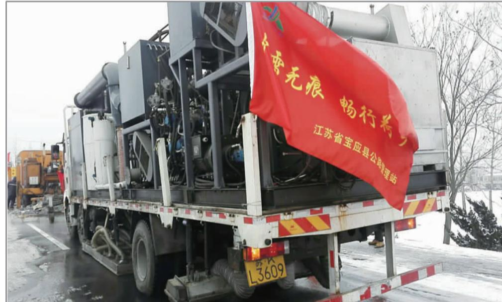
1月28日清晨,县公路站与江苏奥新科技有限公司取得联系,请求其派除雪冰车予以支持,保障公路安全畅通。图为县公路站人员与奥新科技人员一同赶赴332省道宝应运河三桥进行除冰雪工作。可喜的是,桥梁桥面经过红外线和蒸汽加热除冰雪,截至12时47分顺利打通了一个安全通道。这是红外线和蒸汽除冰技术首次在扬州干线公路试验并取得成功。
