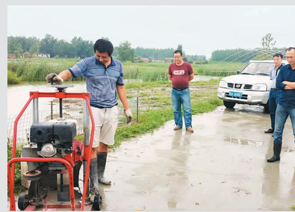
日前,市交通局检测中心、县交通局县乡公路站等单位,冒雨赶赴双墩镇,对2013年“村村通”道路工程质量进行检测。本次检测的路段为河东至付洼段以及新集至河西段“村村通”道路延伸工程。检测对道路的宽度、路肩以及涵洞等道路质量指标进行了逐一查看,尤其是对砼路面浇筑的厚度、强度进行了现场随机“扒皮取芯”,带回检测,给道路质量一个权威的结论。(王伟)
