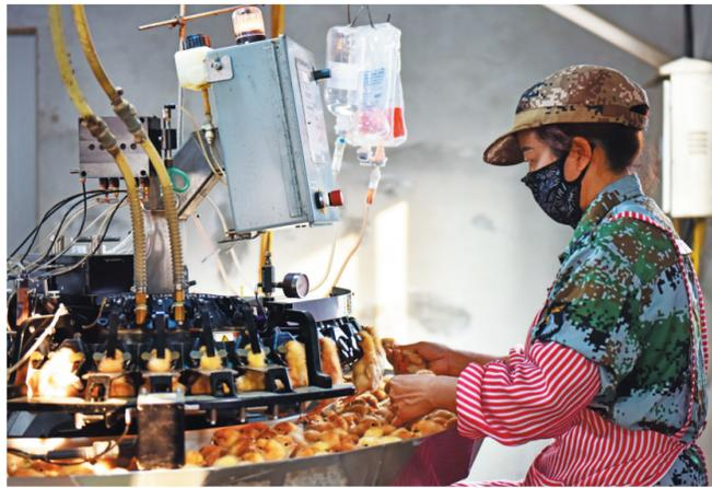
坐落于水湖镇的安徽省安禽禽业有限公司,依托科研院所开展技术合作,实现年产优良蛋雏鸡2000多万羽,商品蛋鸡50万只,产品销往全国10多个省区。图为该公司利用引进先进设备进行PSP红外断喙和疫苗自动注射。(融媒体记者 孔根龙摄)
