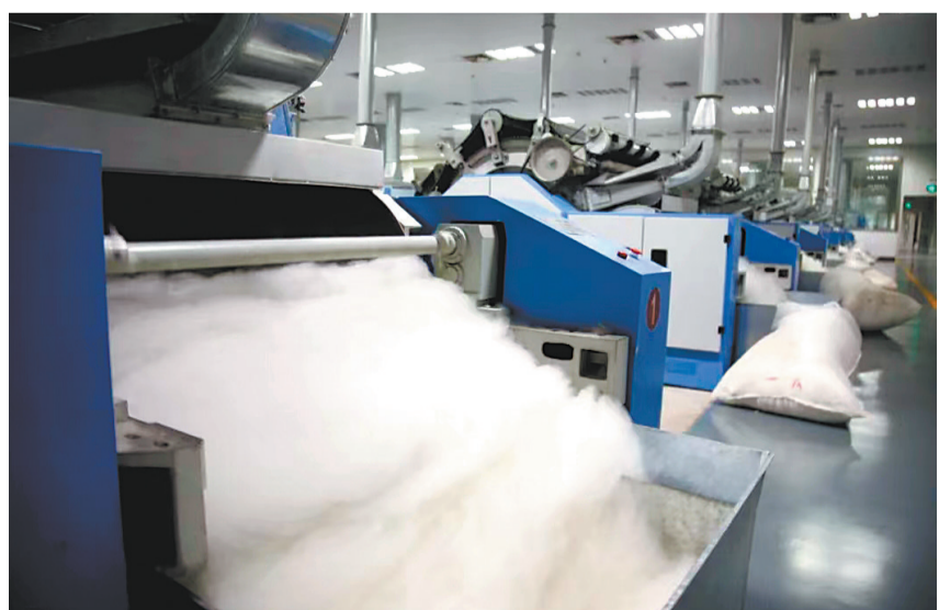
自主研发获得国家专利的风吸式自动化羊绒联合分梳生产线。孟静航摄
