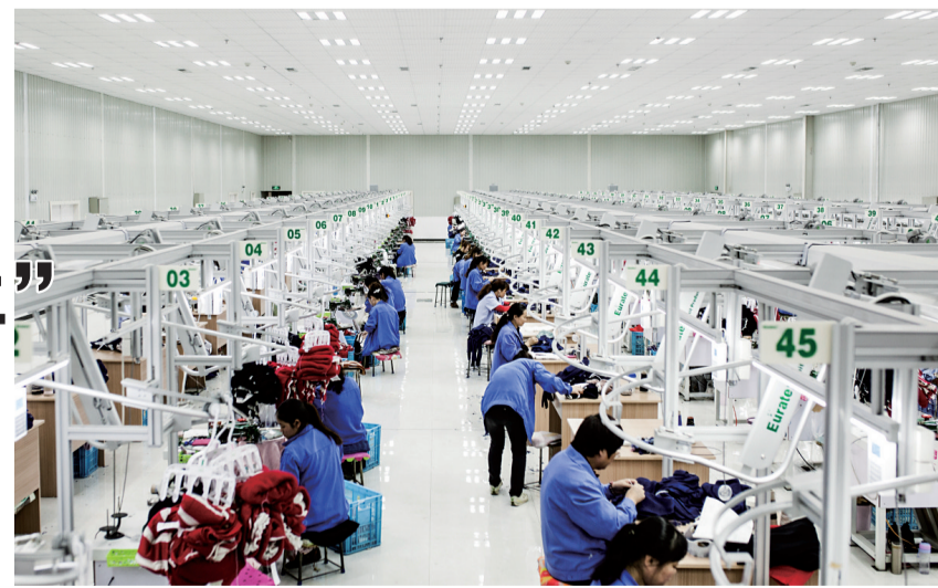
工人在智能全自动制衣吊挂系统车间工作。
