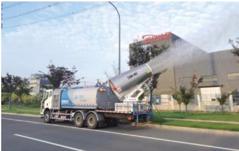
近日,江苏今创环境集团有限公司研发出经开区首台多功能抑尘车,适用于城市主干道、厂区、绿化带等路面清洗和浇灌作业,可对空中喷雾,降低PM2.5值。喷雾系统仰俯角度可实现360度旋转,最高雾炮射程达120米。
