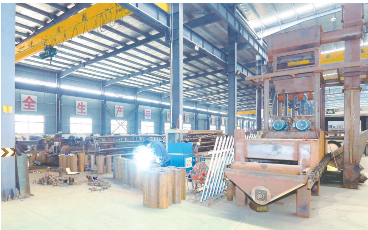
5月15日,江苏久昌机械有限公司生产车间内,工人在焊接抛丸机配件。该公司是一家生产铸造机械除锈、除尘设备的企业,以新型抛丸机生产为突破口,不断提高产品的科技含量和性价比,生产的大型通过式钢板、钢管抛丸清理机等产品畅销全国各地。
