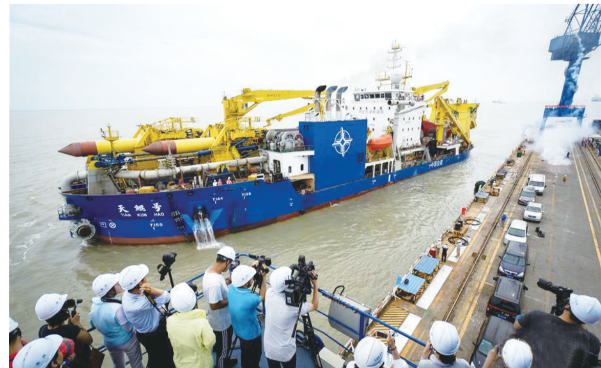
6月8日,“天鲲号”驶离码头出港海试。当日,由中交天津航道局投资建造,具有中国自主知识产权的亚洲最大自航绞吸挖泥船“天鲲号”,缓缓驶离位于江苏启东的船厂码头,正式开启为期3天的海试。“天鲲号”全长140米,宽27.8米,最大挖深35米,总装机功率25843千瓦,设计每小时挖泥6000立方米,绞刀额定功率6600千瓦,此次海试将全面检测并验证船舶动力系统的可靠性和稳定性。(新华)
