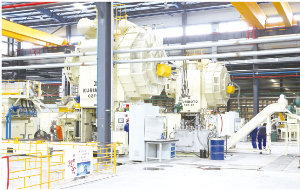
7月9日,在江苏森威精锻有限公司车间内,两条2500吨轮毂轴承自动化热精锻线正在进行试生产。近年来,该公司为适应市场需求,先后投入6亿元进行设备升级,新上了国际先进的自动化热精锻、自动化温锻、配套模具等生产线,可形成年产冷温精锻件10万吨的生产能力。 邱鹏 摄
