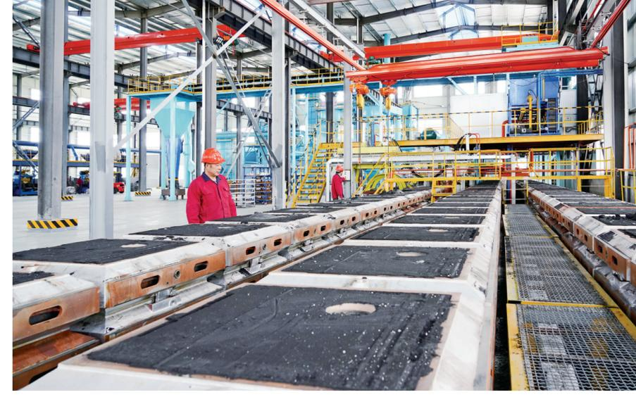
5月28日,盐城市震业机械有限公司的静压铸造生产线上,工人在试生产水泵壳、阀体。据悉,该公司总投资1亿元,一期自动化精密铸造生产线已进入试产,二期机械精加工预计明年上半年竣工。项目全部达产后,可年产汽车零部件5000吨、船舶机械配件3000吨、工程机械及其它配件2000吨。 单培泉 沈丹丹 摄
