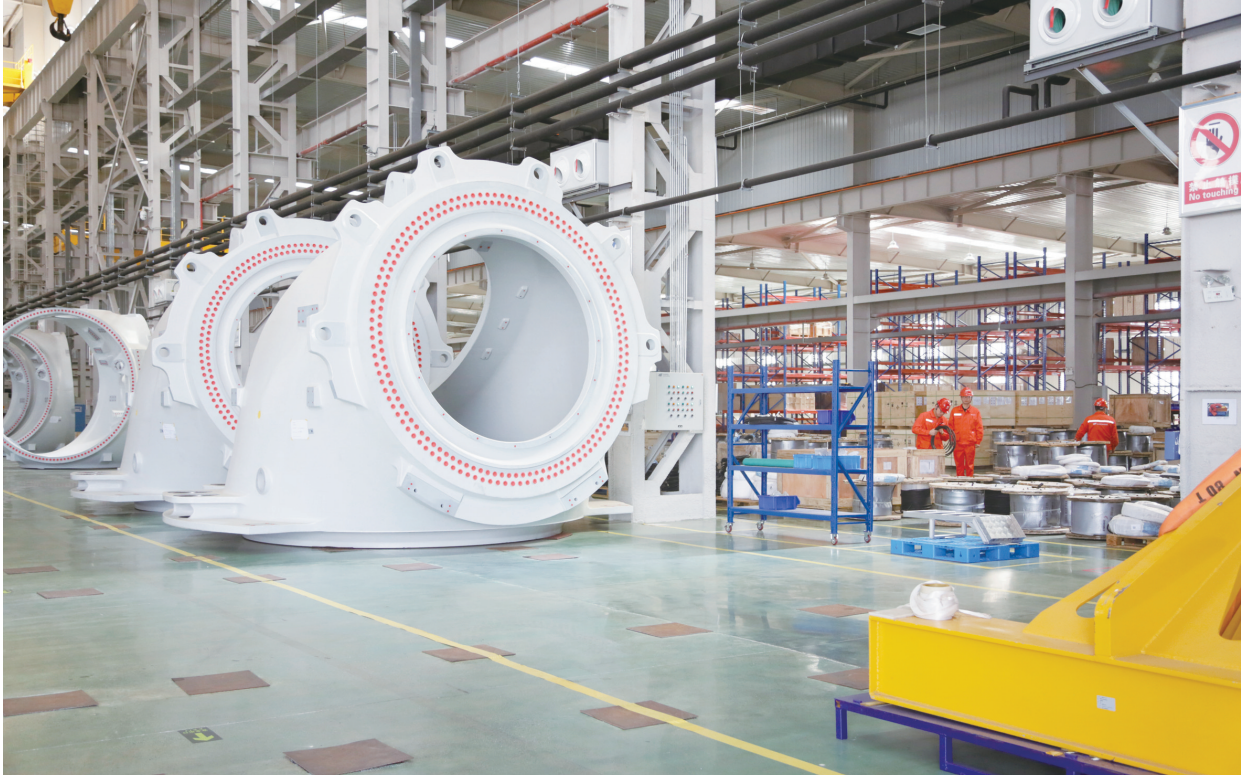
10月29日，金风科技大型海上风电设备智能化生产线项目现场，技术人员在安装风电电机。据悉，该项目总投资1.33亿元，去年4月份正式开工建设，目前已竣工投产，形成年产6MW级及以上海上风电机组100台套、计600MW的大型海上风电机组的生产能力，为战略性新兴产业发展再添新动能。 万成 摄
