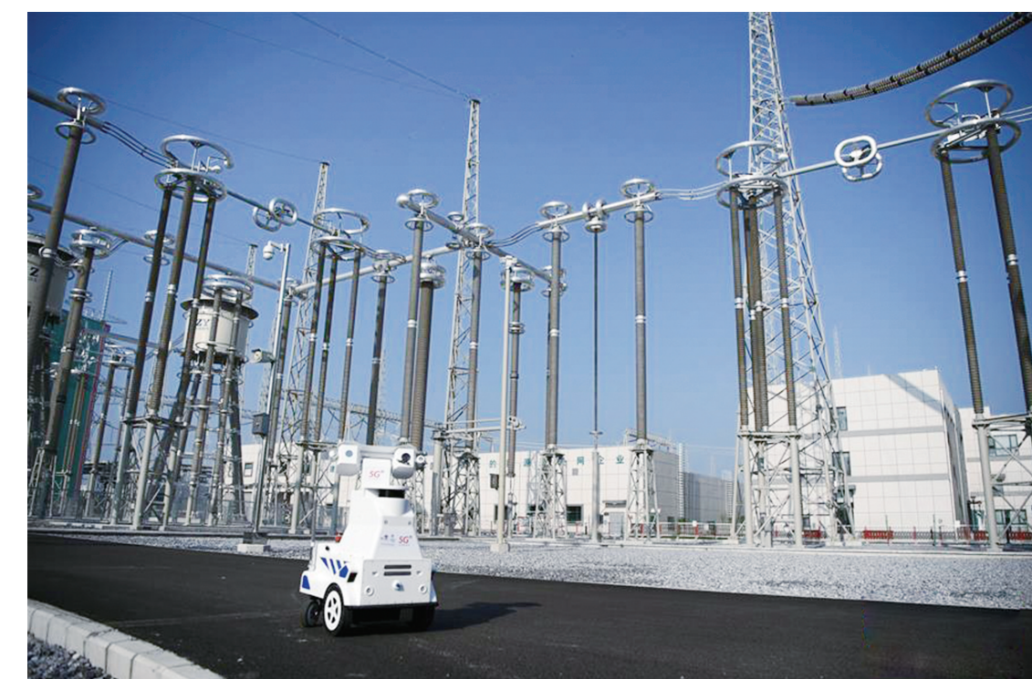
8月27日,巡检机器人在变电站内巡检。在青海—河南±800千伏特高压直流工程豫南换流变电站内,基于5G网络的“慧眼”全方位监视着站区。针对特高压变电站规模大、设备种类多的特点,该电站于今年5月实现5G网络站内全覆盖,配置适用5G网络的巡检机器人、无人机及高清视频监控设备,提升巡检监视设备的感知能力,确保特高压工程安全平稳运行。新华
