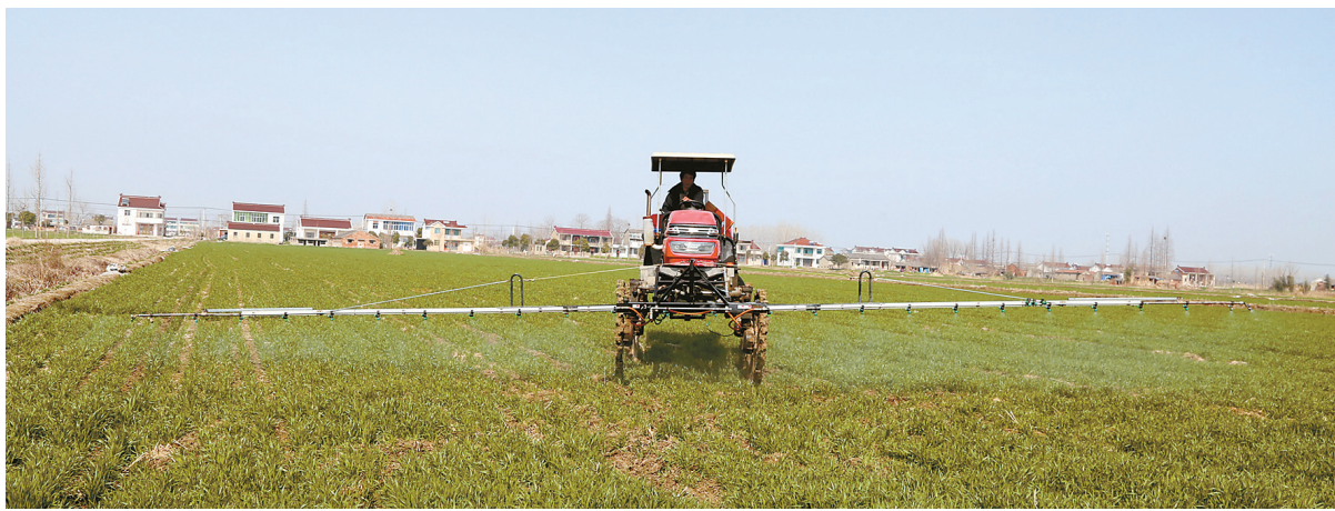
南沈灶镇安云村8组规模种植户崔业前正驾驶自走式植保机喷洒农药,一天可完成200多亩,与传统人工植保相比,工作效率提高了十倍,还提高了农药利用率,大大节省了植保成本。记者 戴海波 摄
