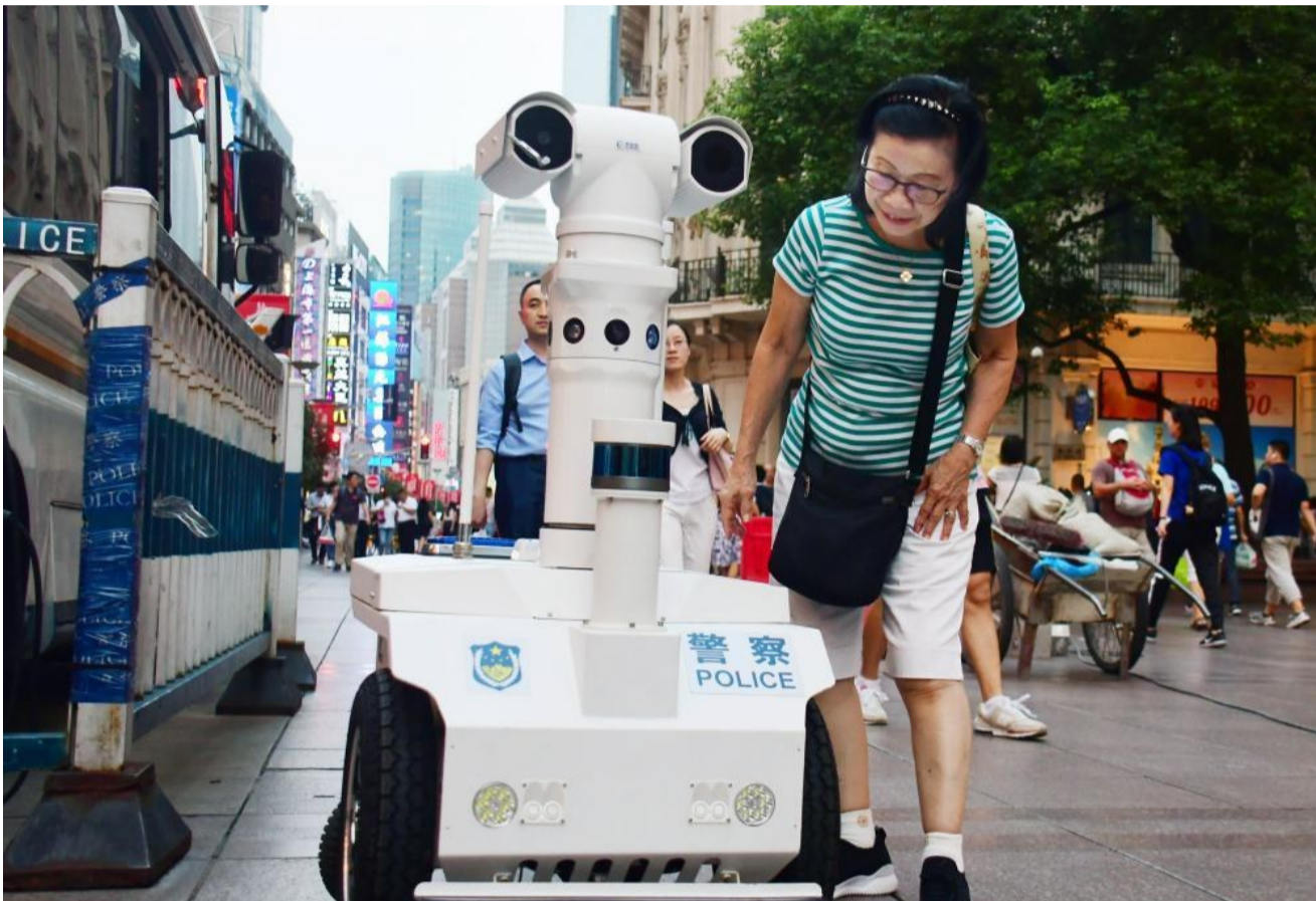
中城首位机器人“警察”近日正式在南京路步行街上岗巡逻,引来不少路人游客的好奇观看。这位机器人警察学名警用巡逻机器人,它搭载了4路广角高清摄像机、1路红外热成像及1路变焦高清摄像机,实现全景无死角巡逻。机器人自带的升降式巡检云台,可以全角度旋转,最高可升至1.8米。除此之外,机器人还可以根据不同场景播放不同的防范宣传内容,实现现场图像的实时传送。据悉,搭载5G网络后,机器人传输的图像将更清晰,现场与后方的实时互动也将更方便快捷。
