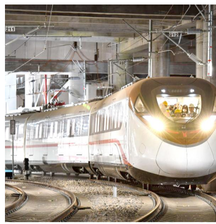
3月3日,广州地铁18号线时速160公里电客车缓缓驶出停车位进行热滑试验。3月3日凌晨,广州地铁18号线时速160公里电客车在横番3号风井至番禺广场站进行全线首次热滑试验,以对该线地铁供电、信号、通信、线路、机电等系统设备进行全面检测。
