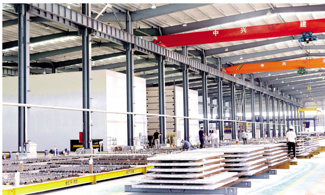
中兴PC构件一期生产项目投资约3.8亿元,占地100亩,建筑面积3.2万平方米,主要产品为预制楼板、预制墙板、预制楼梯板和各类型PC部品件等。预计竣工投产后年开票销售4.5亿元,增加就业岗位300多个。 胡子妍 尹晓晓 摄
