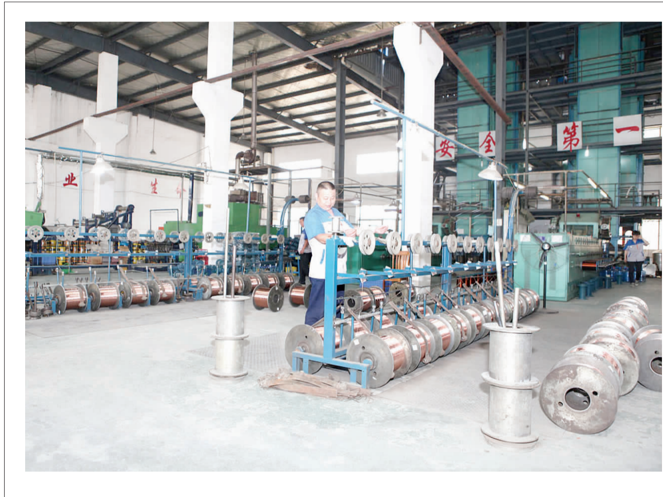
江苏恒金铜业有限公司位于淮阴区徐溜镇工业集中区,占地八千多平方米。现产品主要用于电动机、发电机、电动工具、变压器等,为缓解就业压力和乡村振兴作出了贡献。图为车间工人将铜线拉丝分卷。
