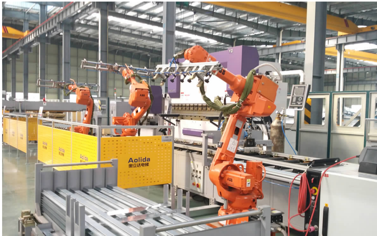
杭州奥立达电梯有限公司的轿壁生产线
