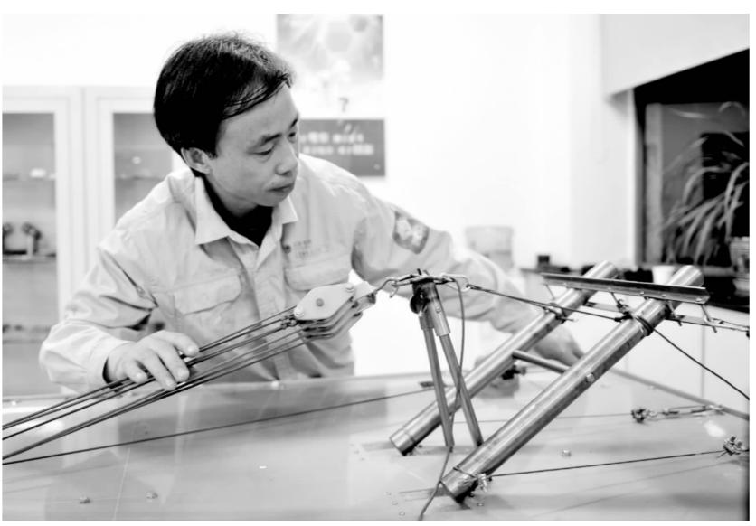
“在带电作业中，我总是要问，过程能否再简单，安全性能否再提高。”陈继祥发现，带电固定导线需要长时间徒手旋转操作杆，劳动强度大、效率低。他就酝酿着自制一种适用于带电作业的电动工具。利用所掌握的机械知识，他从早期的草图构思、材料选型一点一滴入手。由于缺乏必要的制作工具，个别工件只好找加工师傅帮忙。
