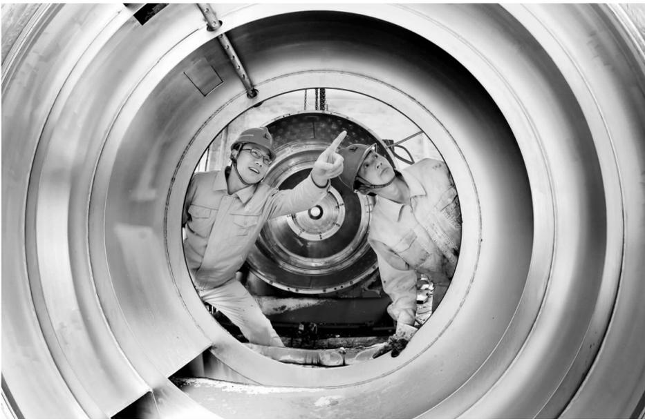
连云港碱厂日前对煨烧车间7台原浆进口离心机的核心部件活塞、换向阀进行调整优化,并成功运用国产备件替代进口活塞和换向阀,仅此每年节约配件进口费用200余万元。朱华南 摄
