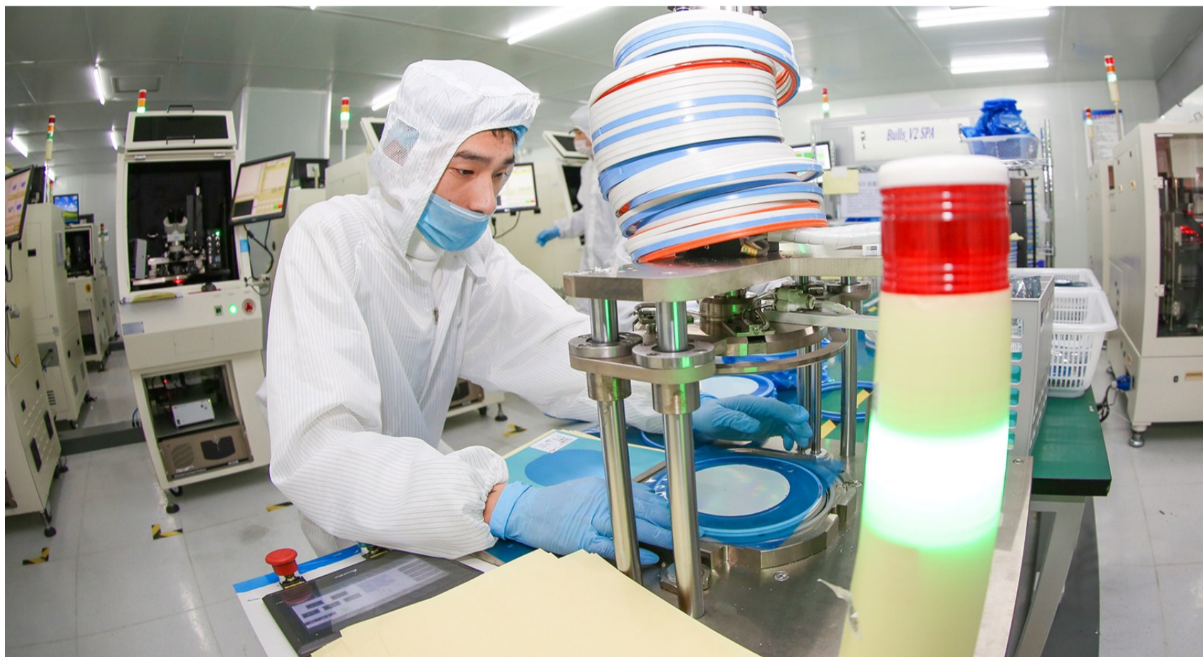
江苏英弗德电子有限公司是一家专业从事红外芯片及红外激光芯片生产和销售的企业，产品主要应用于人工智能、可穿戴设备、3C产品、摄像安保、探测、激光测距等领域。今年以来，该公司在注重产品质量及研发的同时，积极开拓市场，订单已排至明年年初。图为工人进行扩膜作业。 徐洲摄
