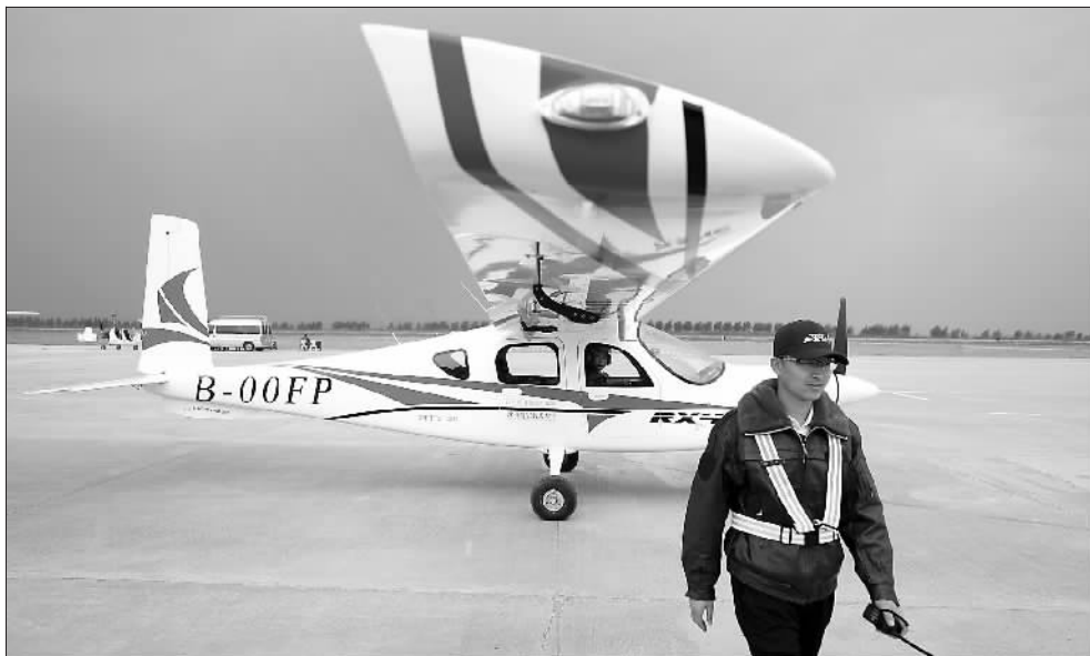
昨天上午,随着一阵轰鸣声,我国自主研发的首架四座电动飞机 RX4E 飞机冲破风雨,在辽宁沈阳财湖机场首飞成功。四座电动飞机 RX4E 飞机是由辽宁通用航空研究院全新研制的新能源通用航空产品,飞机翼展 13.5 米,机长 8.4 米,起飞重量达 1200 公斤,续航时间 1.5 小时,航程 300 千米。
