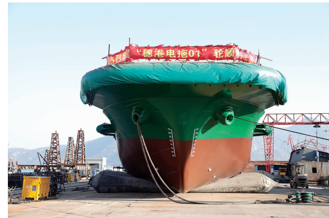
昨日,由连云港港承建的华南地区首艘纯电拖轮广州港“穗港拖01”轮主船体在连云港港纯电拖轮产业示范基地顺利上水。该项目也是港口对外承建的首个纯电拖轮订单。该船设计为4000马力纯电拖轮,电池容量为5934千瓦时,船长38米、型宽10.5米、型深4.8米,设计吃水3.7米。目前,在连云港港纯电拖轮产业示范基地内,同时有5艘纯电拖轮在建。
