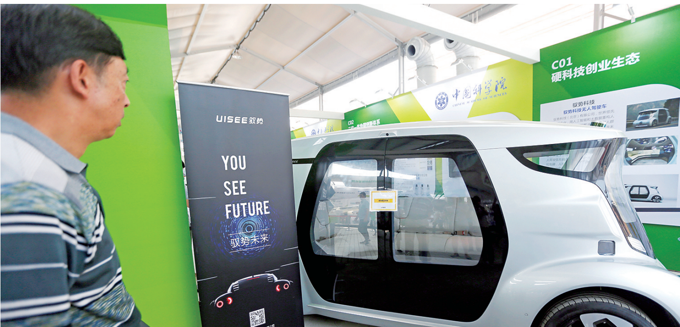
9月18日，上海举办的全国双创周主会场上，无人驾驶汽车引人注目。无人驾驶汽车包括了无人驾驶专用底盘，基于深度学习的感知方案与关键传感器，无人驾驶信息融合和规划控制解决方案与整车控制器，实现人机交互与智能交通数据管理。 □东方IC 供图
