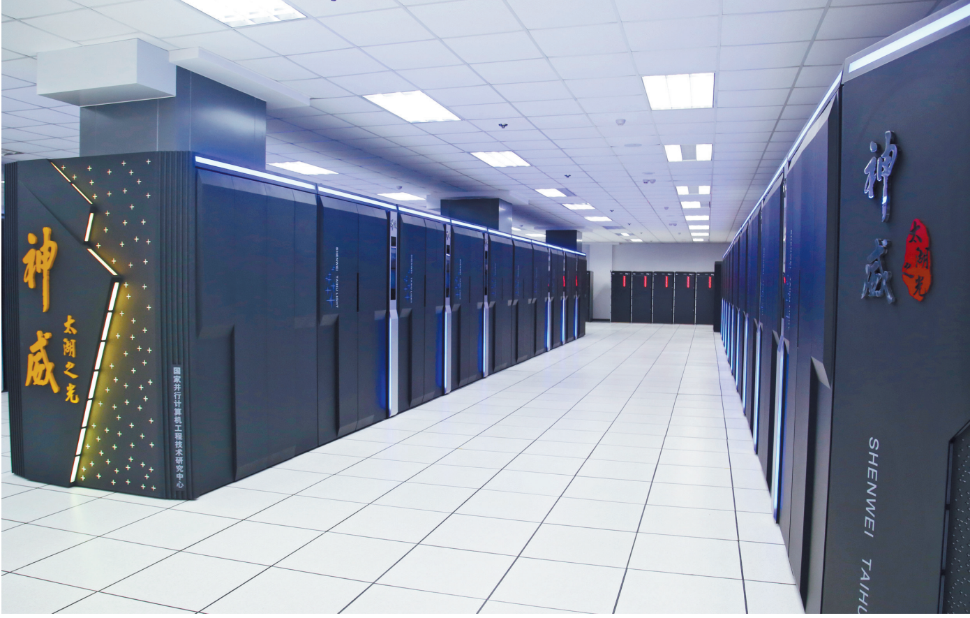
神威·太湖之光超级计算机安装了40960个中国自主研发的“申威26010”众核处理器。
