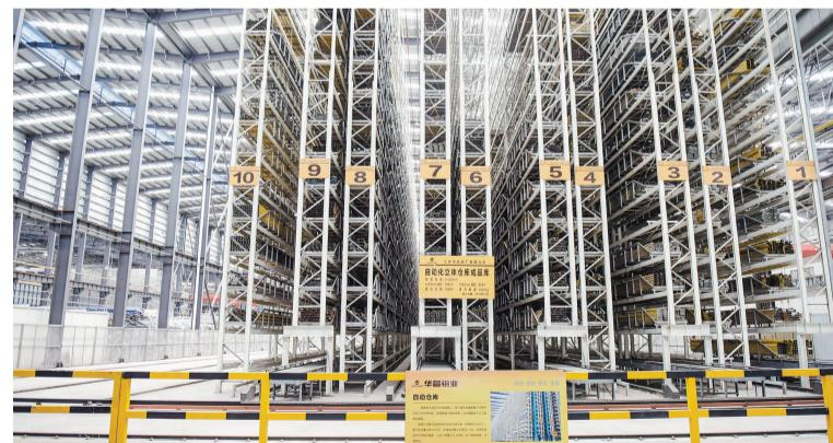
成品铝材被自动“送”上传输带,根据电脑指定进入不同层次的存储位置,随机“上架成功”的信息实时显示在电脑屏幕上。在华昌铝厂三期,随着自动化立体成品仓库的投入使用,这样的场景已屡见不鲜。据介绍,该仓库最大存量达6000多吨,和以往相比,出入库效率提高了200%。
