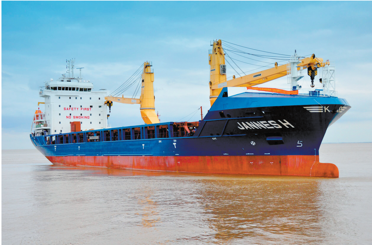
10月31日,宏强重工为德国船东建造的HQ089/12550DWT多用途重吊船顺利交付。该船是宏强重工今年以来交付的第10艘船。该船总长147米,型宽22.80米,型深11.55米,设计吃水7.50米,入DNV-GL级。今年6月下水,9月试航,经过各项严格测试,所有项目均符合设计要求。潘杨 董秋毫摄
