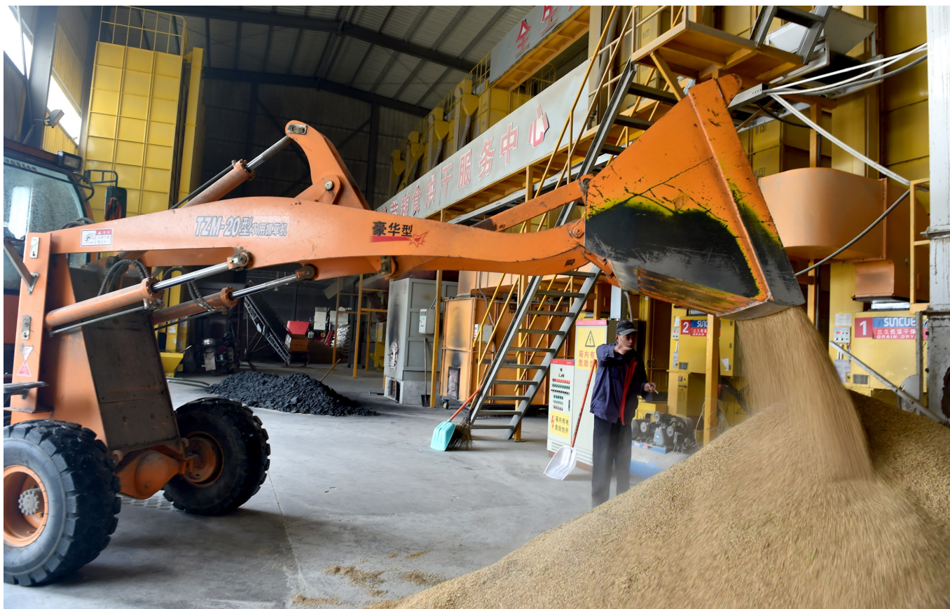
12月13日,合作镇锦荣农机合作社2000多平方米的粮食烘干中心,烘干机械在忙碌运转,工人将水稻倒入进料口,水稻通过进料口进入提升机,经过振动筛将杂物去掉,再进入烘干机。该粮食烘干中心于2014年建成投运,是我市目前最大规模的粮食烘干中心,拥有11台烘干机械,日烘干能力125吨,除满足合作社本身的生产需要外,还为周边种植大户提供服务。 潘杨摄
