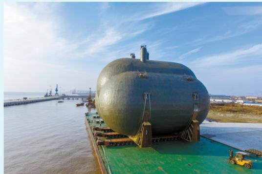
江苏华滋海洋工程 85000立方大型乙烷、乙烯液罐
