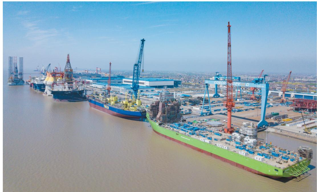
3月19日，启东中远海运海工舾装码头上，N829风车安装船（右一）和“彩虹”轮（右二）建造已接近尾声。据悉，N829风车安装船配备有世界先进的LNG双燃料主机、8台大功率推进器、DP3定位系统、八点系泊及目前海上风电安装维护类项目中全球最大的5000吨主吊机等海工高端装备，主要用于海上风力发电机的运输与吊装。“彩虹”轮则是生产储油船，建成后将成为一个新型的海上化工厂。
