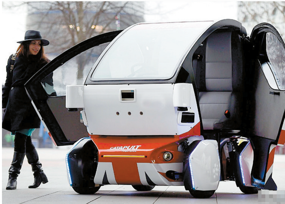
近日,英国政府宣布无人驾驶汽车可以合法上路,而就在当天,英国第一辆无人驾驶汽车Lutz Pathfinder正式亮相。跟Google无人驾驶汽车一样,Lutz Pathfinder也选择了卖萌路线,不过相较于前者的呆萌,Lutz Pathfinder则多了几分犀利,Lutz Pathfinder由英国公司RDM Group设计和制造,主要用作短途出行,该车续航8小时,最高时速为24km/h,先进的传感器依然成为无人驾驶汽车的标准配备。
