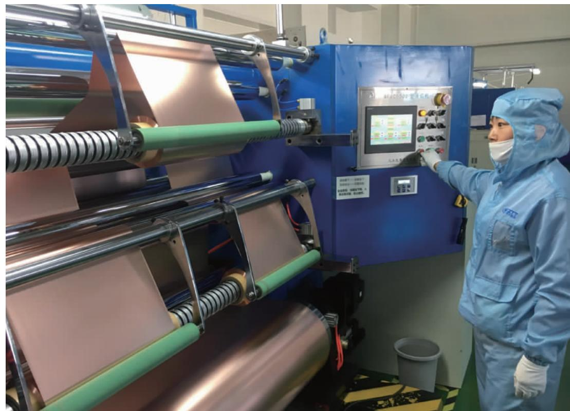
27日,中天科技江东电子材料有限公司铜箔生产车间内,工人正在操作铜箔分切机,江东电子铜箔一期项目建设两条年产5000吨铜箔生产线,目前8微米、6微米铜箔(世界上最薄电子铜箔)生产设备均已调试成功,投入试产。试产期间,产品除供应中天储能公司作为生产原料外,还小批量供应给鼎鑫电器、海四达、三杰新能源等国内企业。
