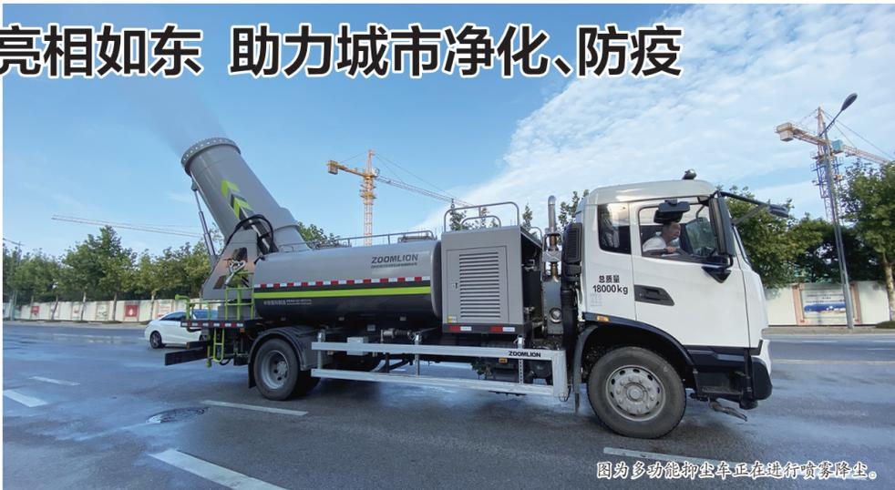
图为多功能抑尘车正在进行喷雾降尘。
