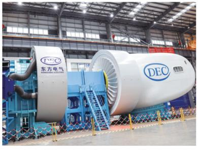
东方电气风电有限公司自主研制的中国首台、全亚洲功率等级最大、叶轮直径最大的10MW抗台风型海上风力发电机组
