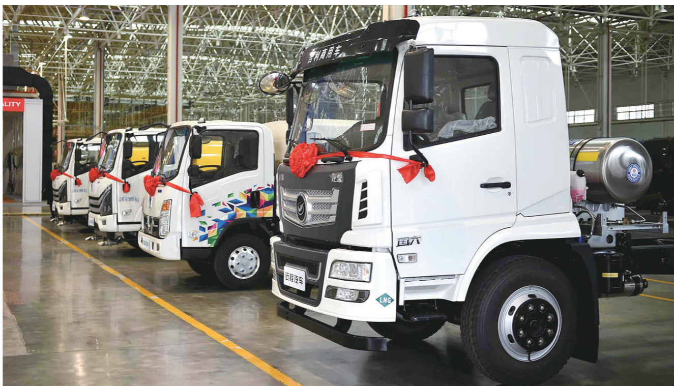
12月18日，吉利新能源商用车增程式环卫产品批量生产暨交车仪式在南充市嘉陵区吉利商用车总装车间举行。此次首批交付的增程式环卫车共计8台，主要投放于南充市城区，用于环境卫生保洁，十二月底前将全部上路运行。”吉利商用车有限公司相关负责人说。 据了解，吉利远程增程式环卫车，搭载吉利自主研发的e-GAPF增程式技术，配备1.5T高效增程器，续航里程超过500公里。同时，该车配备了54.72度大电量电池，纯电模式下续航里程达120公里，实现油电模式一键切换，适合长时间城市作业，是国内为数不多同时拥有新能源路权与超续航能力的环卫车型，每公里使用成本低于燃油车。 杜成澄 四川经济日报记者 李国富 摄影报道
