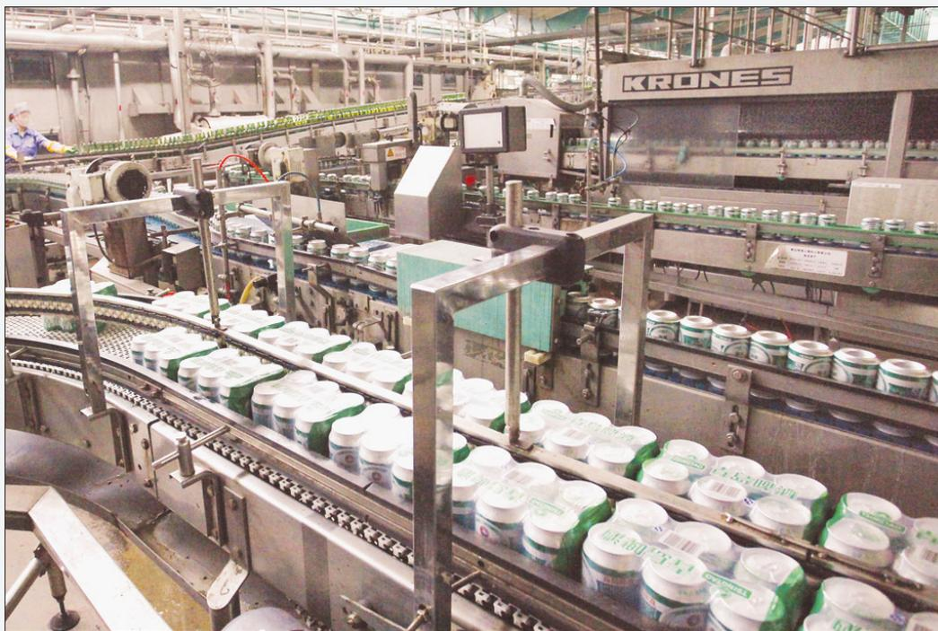
世界杯北京时间明天即将开幕,青岛啤酒是众多球迷的激情伙伴,预计世界杯期间销量会有很大突破。在青岛啤酒上海松江制造有限公司生产车间内工人们正日夜不休抓紧生产。据2号听装线负责人介绍:“啤酒从完成发酵、过滤等工艺的啤酒在‘2号听装线’生产线(见上图)上经过灌装、压盖、杀菌、塑包,最后装箱,从生产线进入仓库。该生产线每12小时可生产35万听啤酒,除正常维护清洗外,几乎24小时都在生产。” 记者 陈燕/文 岳城/摄
