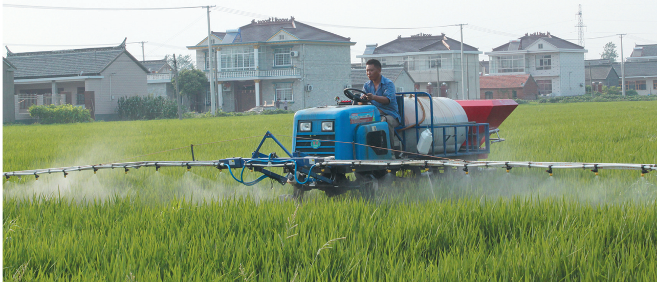
9月1日,盐城市植保合作社联合社在高新区盐渎街道成立。该联合社整合发生精耕合作社、加兵农机专业合作社、昕奇植保合作社等资源,充分发挥统防统治功能,为农户提供“保姆式”“一站式”服务。图为该联合社正在使用自主研发的行走喷杆式植保机械对水稻进行“三病三虫”防治。刘丛华 摄
