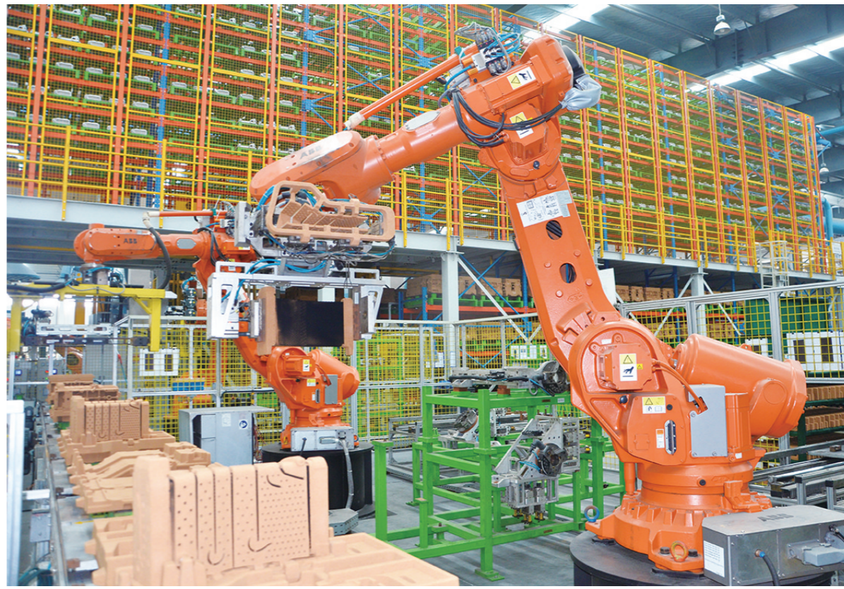
图为苏州明志科技有限公司机械手臂配合完成制模。(杨华摄)
