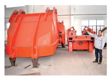
近日,位于昭阳工业园区的兴化市东方机械有限责任公司自主研发生 产出了河道疏浚用"抓斗", 斗容达22立方米, 抓土石量达33吨, 机重 70吨,为国内疏浚行业替代了进口设备,既促进企业转型升级,又为国 家节约大量外汇。
