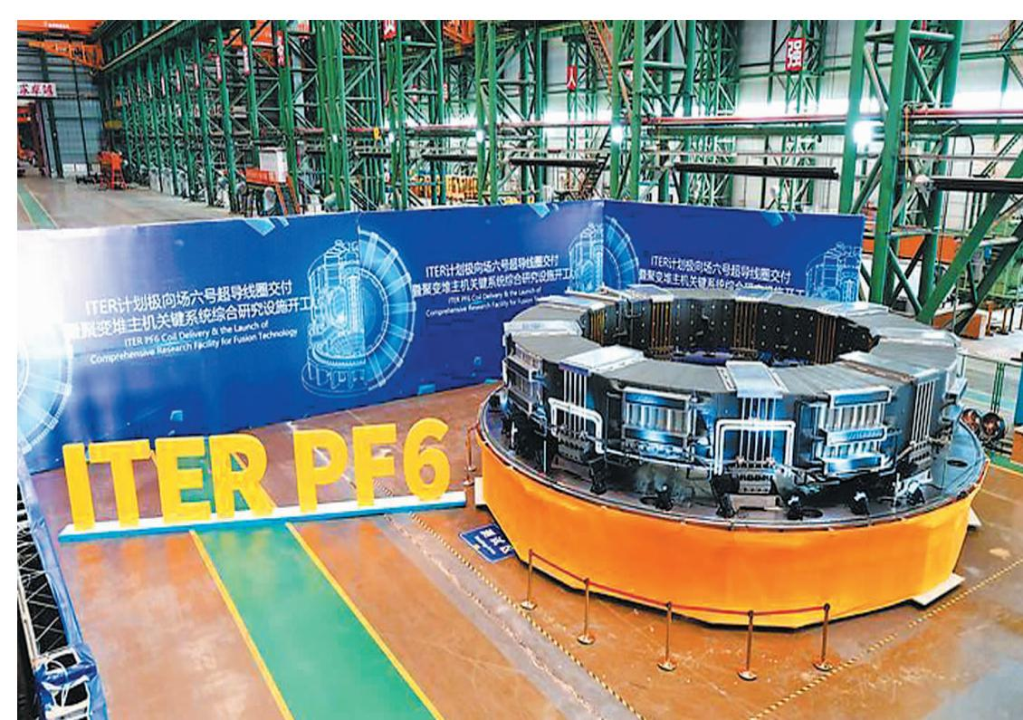
近日,由中国科学院合肥物质科学研究院等离子体物理研究所承担研制的国际热核聚变实验堆(ITER)计划首个大型超导磁体线圈主体,线圈主体外径约11.2米,呈饼式结构,外形类似中国古代的和氏璧。
