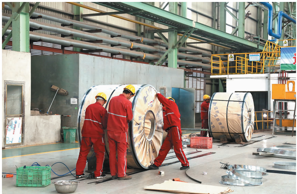
今年以来,德龙公司瞄准带动形成千亿级合金新材料产业园目标,采用当前国际先进的“1+7连轧”生产线,生产的产品尺寸控制精度高、表面质量好,轧制后的不锈钢卷经过固溶酸洗,具有良好的光泽度和耐蚀性。图为近日,工人们正在对轧制好的不锈钢卷进行包装。记者 殷敏峰 摄
