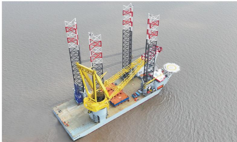
8月25日,圆满完成出海试航的全球首艘3000吨级自升式风电安装船N966返回江苏启东中远海运海工码头。在为期近一个月的出海试航过程中,顺利完成了航行系统试验、插桩、升降试验和主起重机的吊重等试验。近期交付后,将赴英国北海服务目前在建的全球最大装机规模海上风电场。(来源:人民网)
