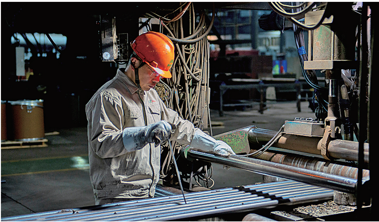
工人在车间内观察水冷壁埋弧自动焊产成品情况 资料图片
