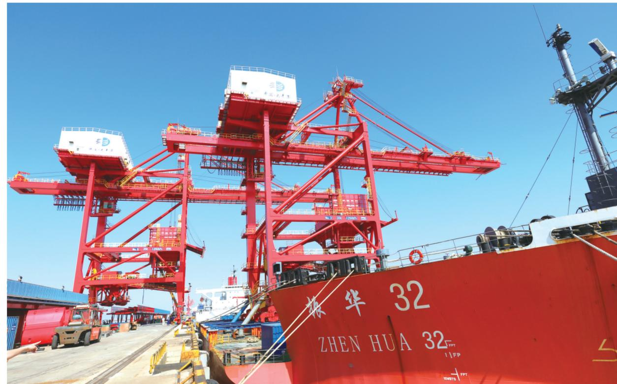
10月10日，2台崭新的1250吨-35T桥式散货卸船机亮相大丰港矿石码头。据悉，这2台散货卸船机投资近亿元，高50米，外伸距40米，可覆盖15万吨级货轮所有舱口。此次散货卸船机的安装，将成为该码头配套的主要设备，提升矿石、煤炭等货物的装卸能力。
