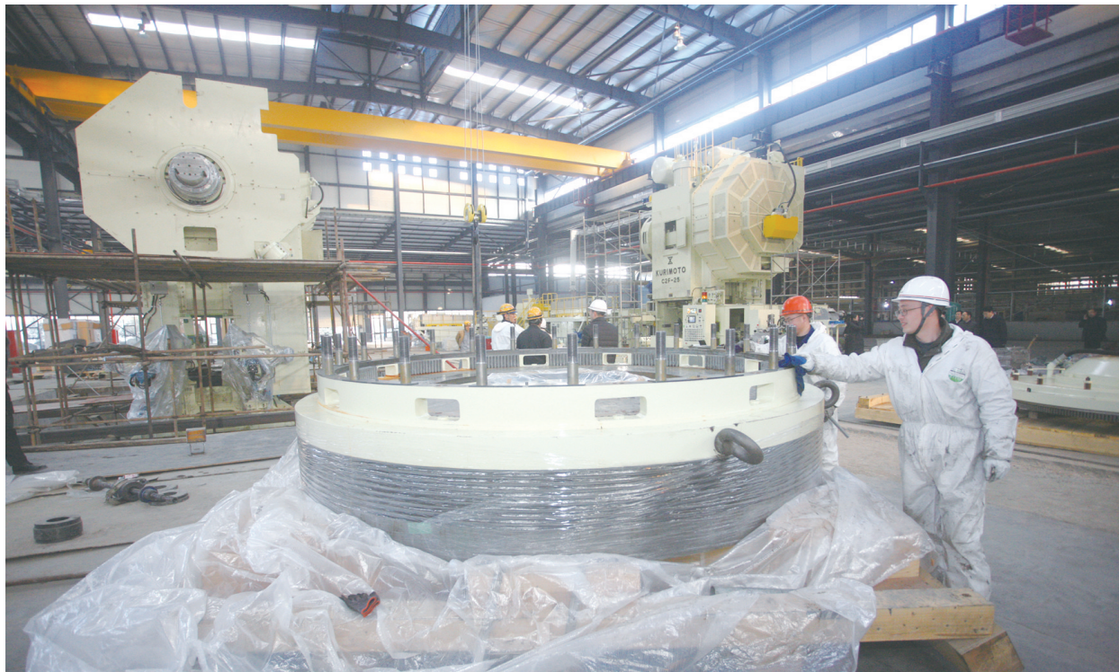
2月24日,森威精锻三期车间内,技术人员在安装新设备。新年伊始,该公司加大技改投入力度,投资8000万元从日本引进两套热锻机从事热锻产品的生产加工及销售,目前设备进入安装阶段,4月份调试完毕后即可进入试生产。 万成 摄
