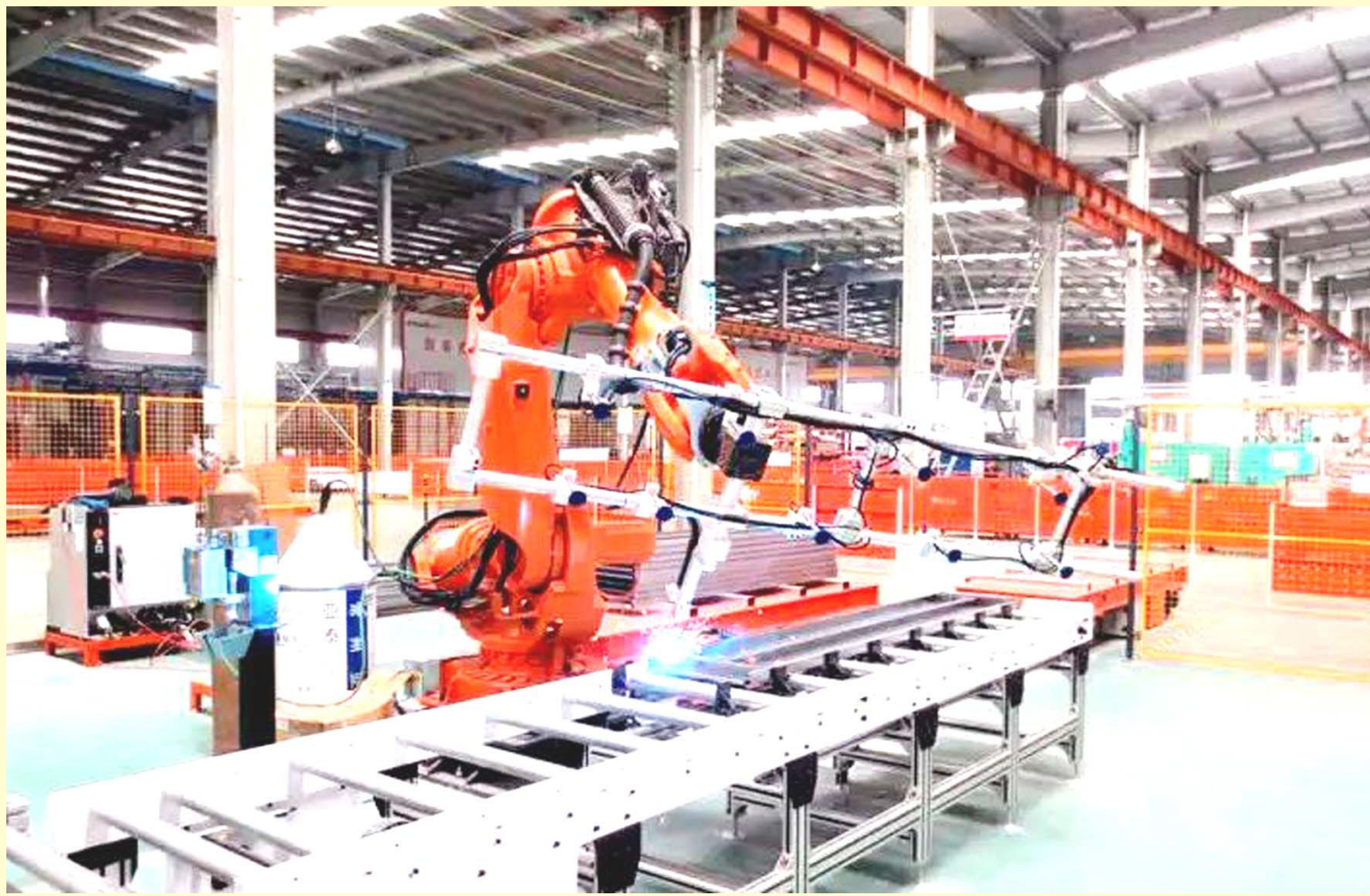
近年来，江苏施塔德电梯有限公司累计投入5000万元，新上10台套机器人设备生产线。“机器人”后，生产效率提高15倍。图为智能焊接传输机器人，与二氧化碳焊机无缝对接，实现焊接、传输自动化。
