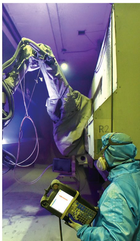
振江新能源自动化机械臂正在进行焊接工序。
