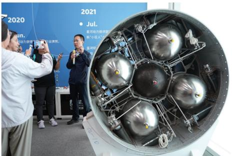
6月18日,北京星河动力航天科技股份有限公司的执行总裁夏东坤在北京经济技术开发区向媒体介绍谷神星一号运载火箭轨控发动机。
