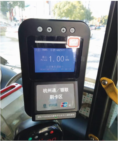
建德公交车上的新 POS 机，下半部分新增了杭州通/银联刷卡区和扫码器
