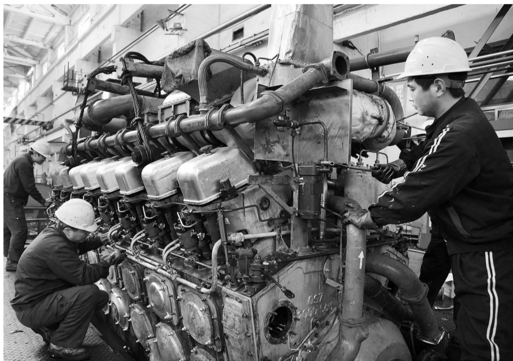
徐州机务段目前开展劳动安全大检查专项整治活动,加大对单岗作业、吊具使用、大部件吊运、作业安全防护等安全关键岗位检查力度,确保机车运输安全稳定。图为检修工正在按工艺要求组装机车柴油机。李文伟 摄
